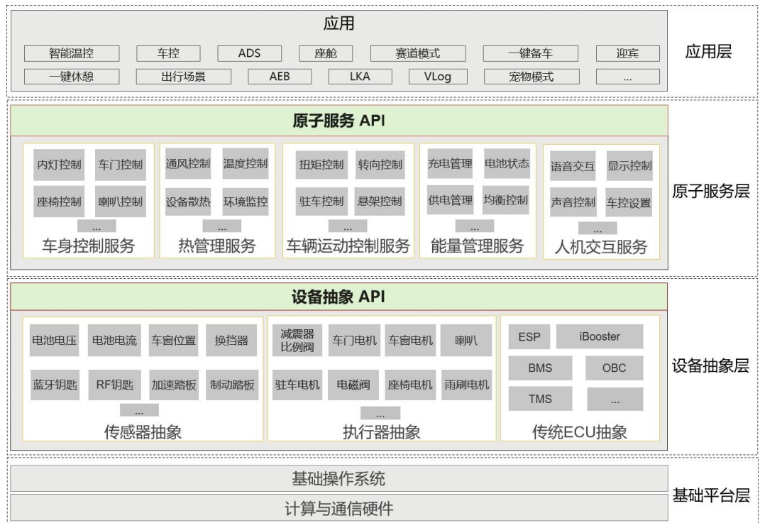
图 3-5 面向服务的软件架构示意图
